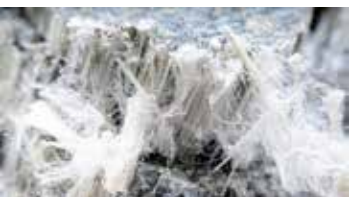
Schon kleinste Fasermengen Asbest können gefährlich sein. Foto: Terry Davis/iWirestock – Adobe Stock
